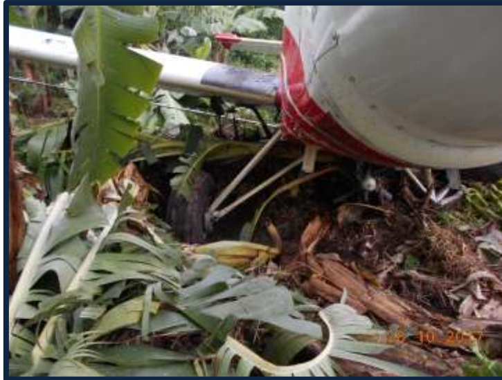
Fotografía No.: 5 Daños en la parte baja del fuselaje
