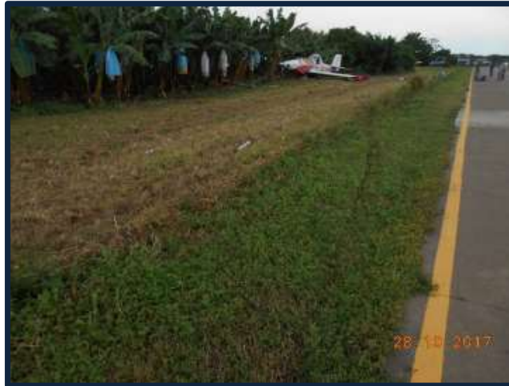
Fotografía No.: 13 Marcas de la distancia recorrida fuera de pista.
