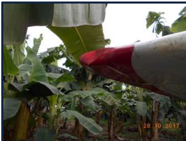
Fotografía No.: 10 Punta del ala dañada.
