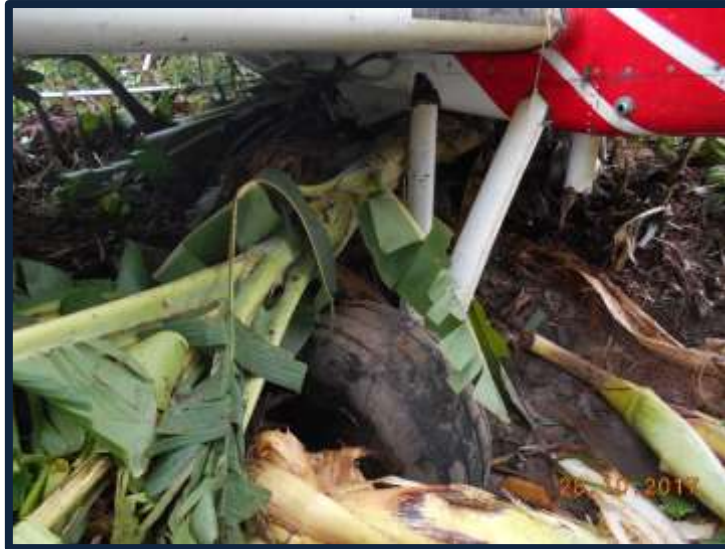
Fotografía No.: 7 Tren de aterrizaje derecho sin daños.
