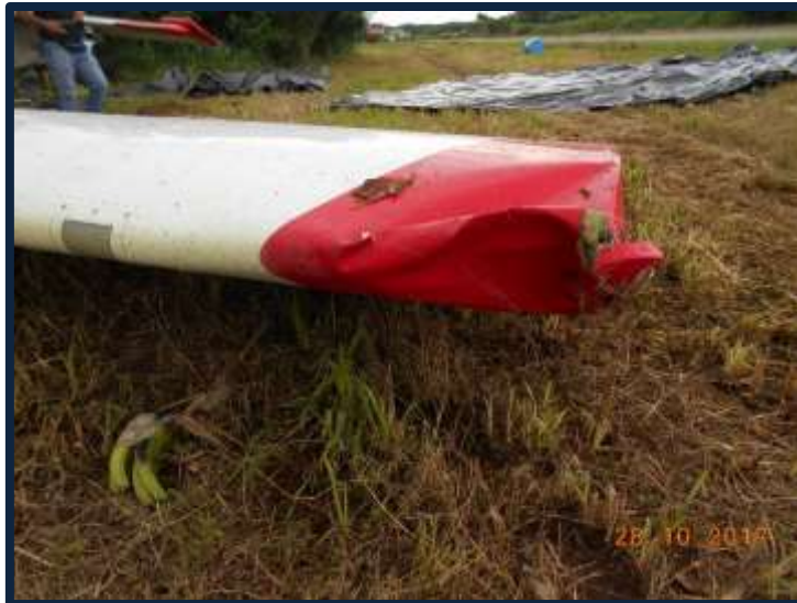
Fotografía No.: 3 Golpe en la punta del ala izquierda.
