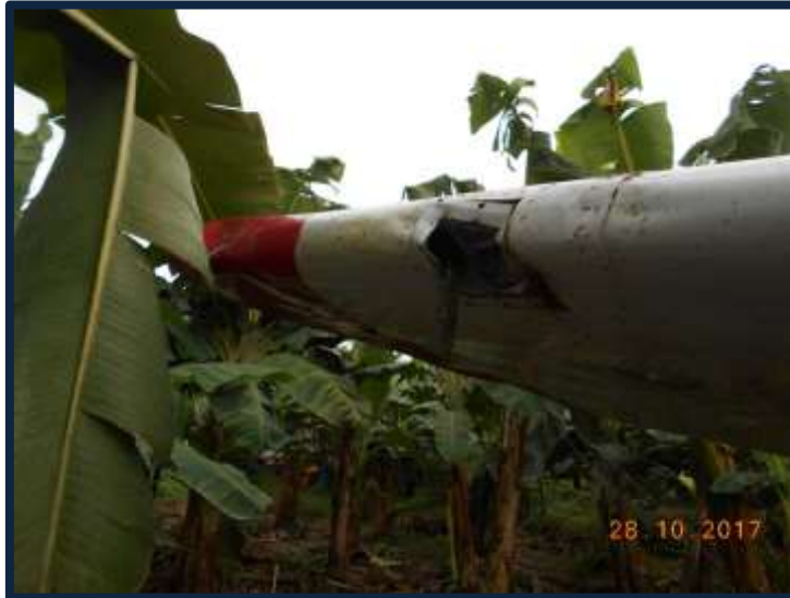
Fotografía No.: 9 Vista del borde de ataque del ala derecha dañada.
