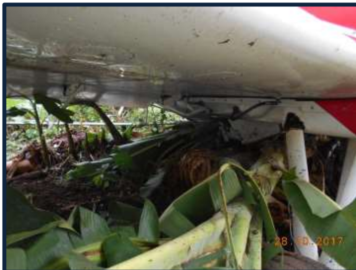
Fotografía No.: 8 Aspersores del ala derecha con daños.
