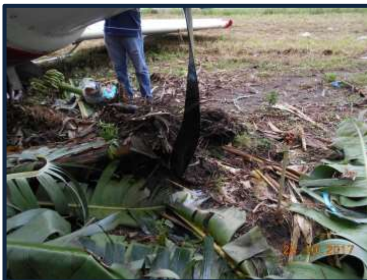
Fotografía No.: 6 Vista del aspa de la hélice dañada.
